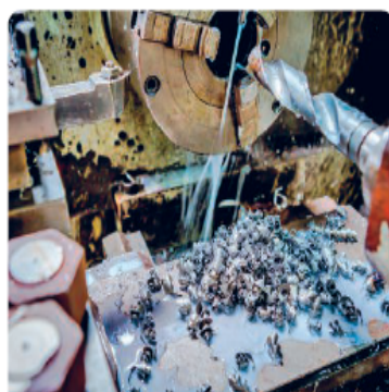
# Figura 6.18 – A usinagem de peças metálicas é feita com o auxílio de um líquido refrigerante, que evita o aumento da temperatura causado pelo atrito da ferramenta com a peça.
