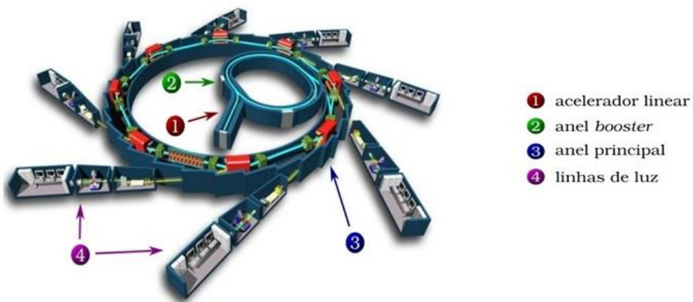
Figura 8 - Esquema genérico de uma fonte de luz síncrotron.
