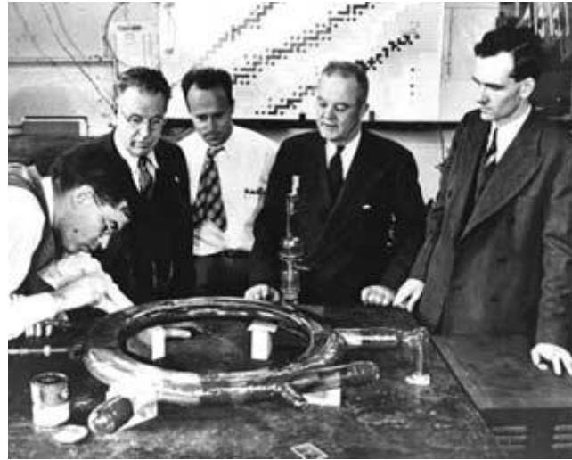
Figura 2 - Câmara de vácuo de um síncrotron da General Electric de 1947.
