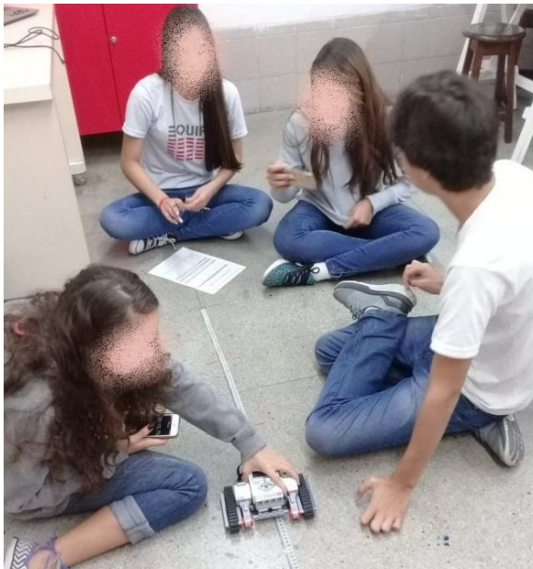
Figura 21 - Momento de levantamento dos tempos decorridos nos trechos de 30 cm para determinar a velocidade do carro
