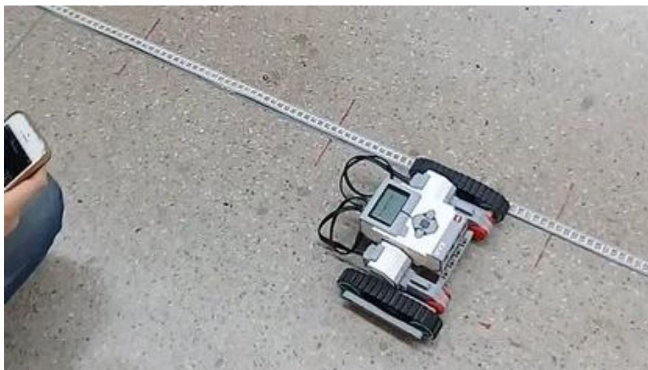
Figura 22 - Detalhe do carro robô se deslocando para determinação da velocidade
