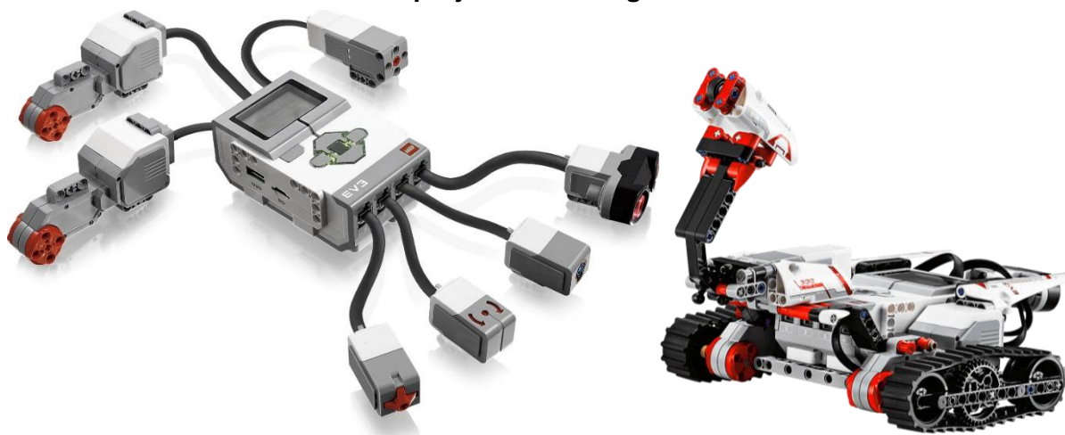
Figura 2 - Processador EV3 conectado com motores e sensores e um exemplo de projeto de montagem
